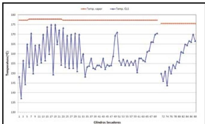
**Figura 8.** Gráfico da diferença de temperatura da superfície dos cilindros e do vapor
